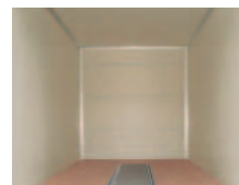
木材を廃止して内 装材には再生PS ボードを使用してい ます(100%リサイ クル材料です)
